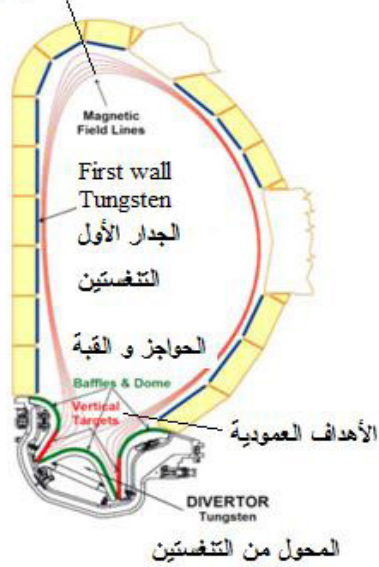
الشكل 7. المقطع العرضي لحجرة البلازما الرئيسية في مفاعل التوكاماك [8, 15].
