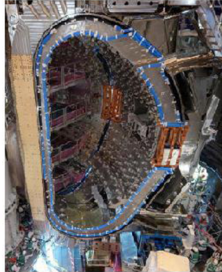
الشكل 7. المقطع العرضي لحجرة البلازما الرئيسية في مفاعل التوكاماك [8, 15].
