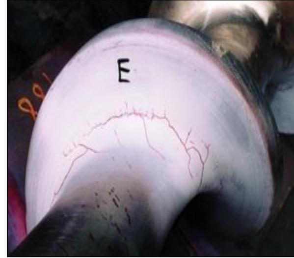
صور مكونات من الفولاذ بعد اختبارها بالصبغ الأحمر تظهر مواضع الكسور عليها.
