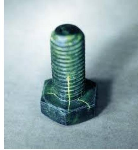
صور لعينتين من الفولاذ بعد اختبارهما بالسائل النافذ المتفلور
