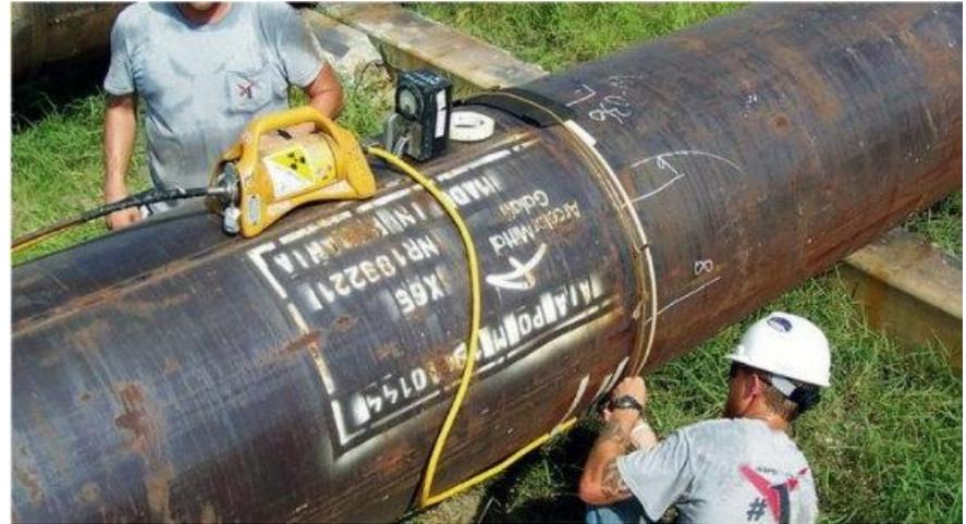
أمثلة للمكونات الملحومة التي تتطلب اختبارات بالتصوير الشعاعي
