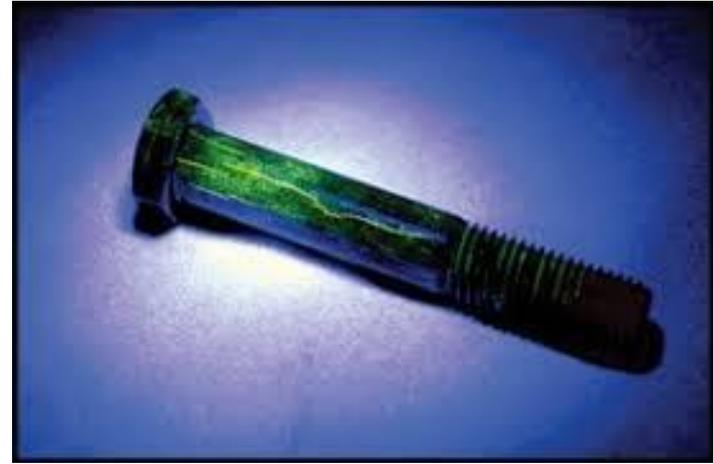
أمثلة على اختبار مكونات معدنية بالجسيمات المغناطيسية المتفلورة بالطريقة الرطبة.
