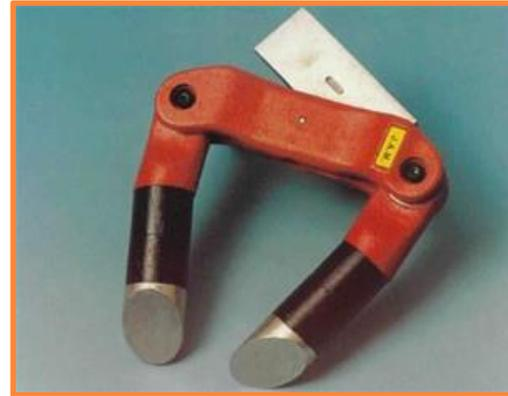
المغطة باستخدام مغنطيس دائم أو مغنطيس كهربائي
