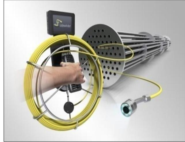
استخدام المنظار الليفي في اختبار الأنايبب في مبادل حراري وفي اختبار
